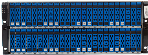
Abbildung 3 – NetApp AFA A800 Front ohne Blende mit 48 NVMe Disks
