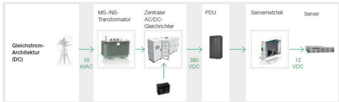
Abbildung 15: Eine DC-Versorgung von Rechenzentren erfordert weniger Komponenten und ist mit geringeren Verlusten verbunden als eine AC-Versorgung (Quelle: ABB)
